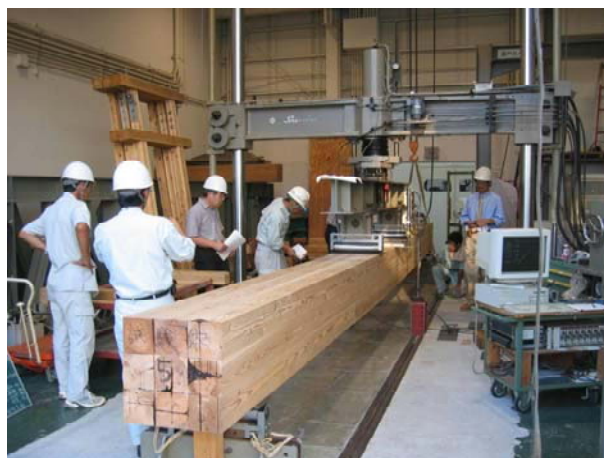
実大試験機による建築部材の曲げ試験 （木材工業部）
