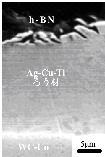
図2 接合界面の断面観察結果(ろう材Aを使用)
