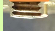
転造タップ成形品の半分断面 0.3mm
