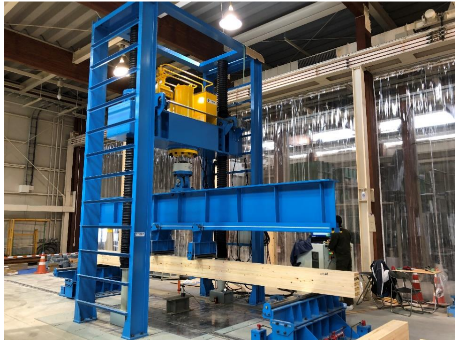
万能実大強度試験機による構造材曲げ試験
